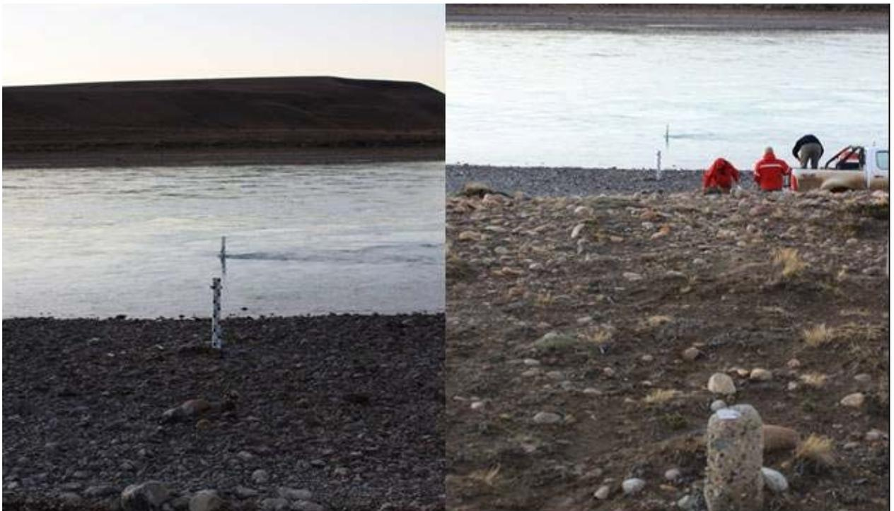
Figura N° 6 – Instalación de Escalas
